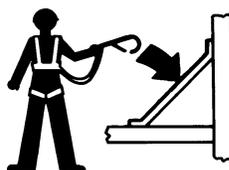
平台上的人员必须佩带安全带或使用符合政府规章的安全设施。将系索系在平台的锚上。
