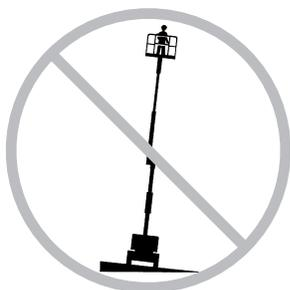
如果平台升起时倾斜警报器鸣响：要十分小心。确定斜坡上臂杆的状态，如下所示。在将机器移动到坚固、水平的地面之前，按照以下步骤降低臂杆。降低时不要旋转臂杆。
