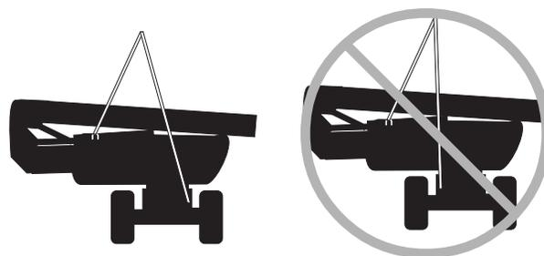
只能将索具连接到离转盘提升点最远的 2 个底盘提升点上。
