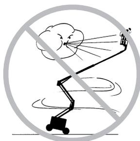
当风速可能超过 12.5 m/s 时不要升起臂杆。如果臂杆升起后风速超过 12.5 m/s，应降低臂杆并且不要继续操作机器。
