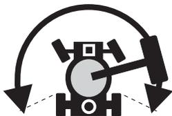
要驱动机器，请按驱动启用按钮，并缓慢移动驱动/转向控制手柄，使它离开中心位置。
